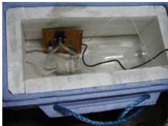
図 13: 微気圧計内部
